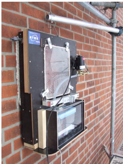
Abbildung. 1: An der HTWK Leipzig wurde ein Wasseraufnahmemessgerät entwickelt, mit dem sich der W_w -Wert einer Fassade bestimmen lässt. Die Abb. zeigt einen Prototyp.
