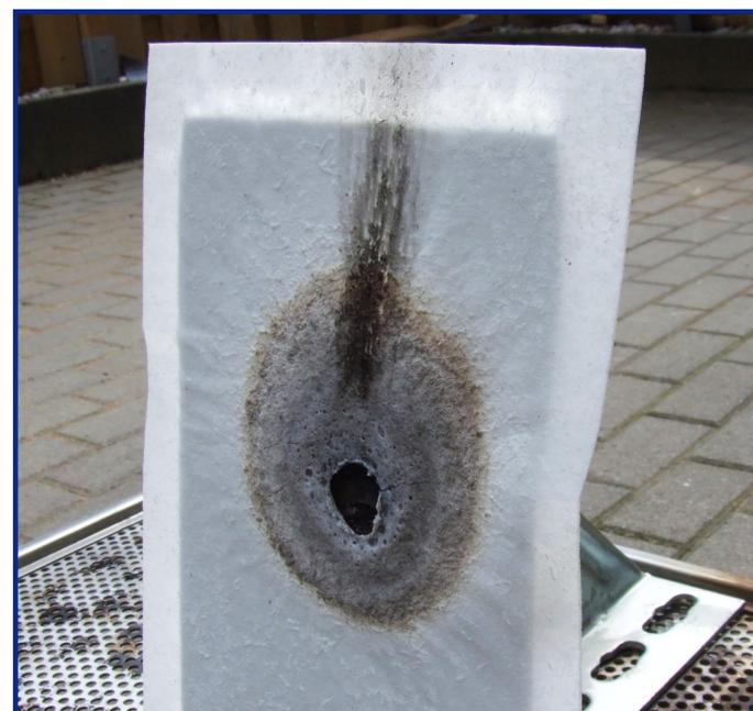
Angestrebtes VIP-Kaschierungssystem nach dem Brandversuch
