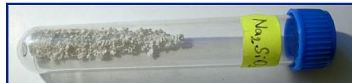
Eine Probe Natriummetasilicat  $\text{Na}_2\text{SiO}_3$
