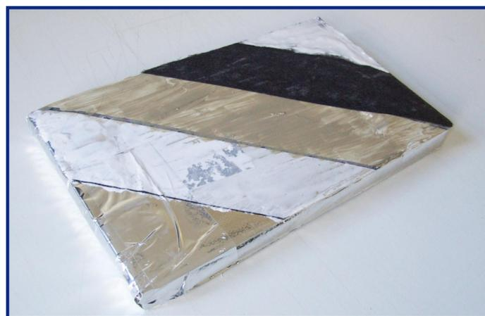
Prinzipieller Schichtaufbau eines kaschierten VIPs: Hüllfolie, Primer, Wasserglasklebstoff, Glasvlies, mineral. Beschichtung
