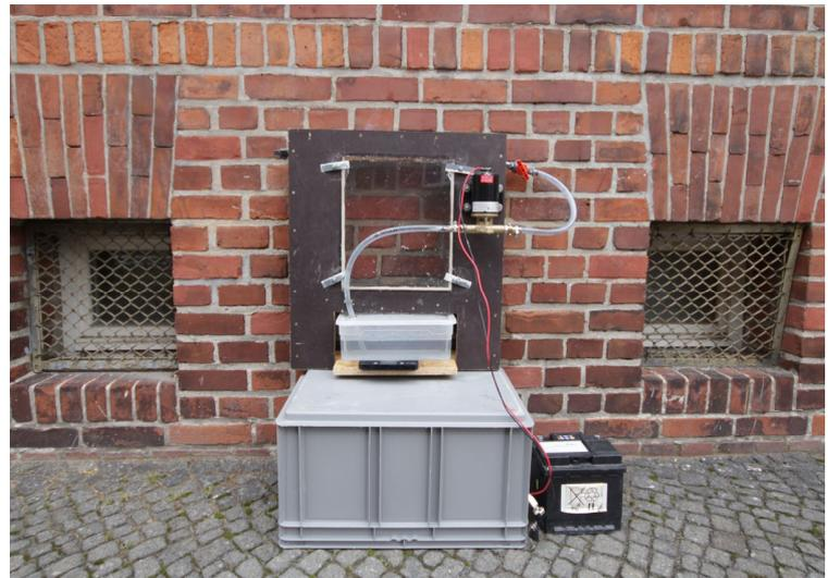
**Bild 6:** Objekt 1 mit Sichtmauerwerkfassade (li.) und das Wasseraufnahmemessgerät im Einsatz (re.)
