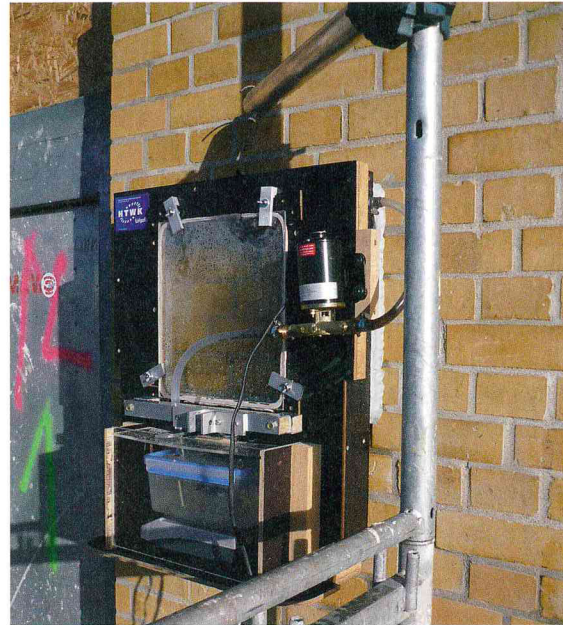
Bild 6. Wasseraufnahmemessgerät Prototyp an Objekt 2
